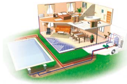
Fussbodenheizung im Erdgeschoss, Klimakonvektoren, oder Heizkörper in Obergeschoss und Beheizen dem Schwimmbad
