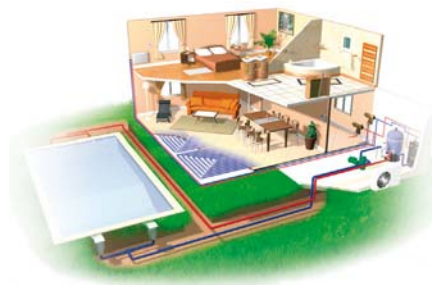
Distribution au sol, ventilo-convecteurs ou radiateurs basse température à l'étage et réchauffage de piscine.
