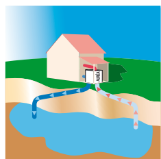
Captage sur nappe
